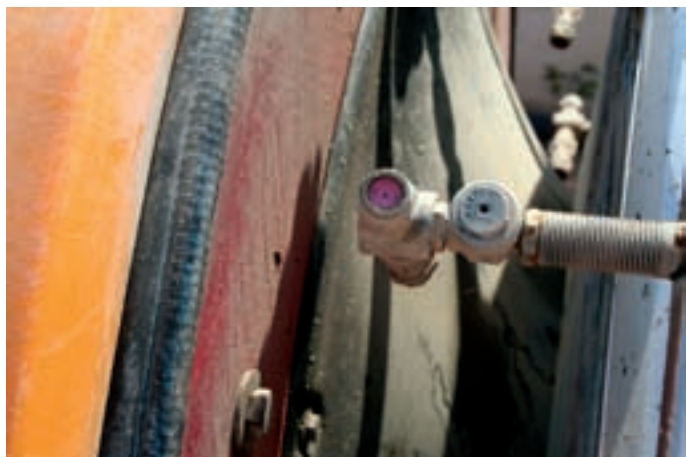
Imagen 12. Detalle de boquilla de cono hueco.
