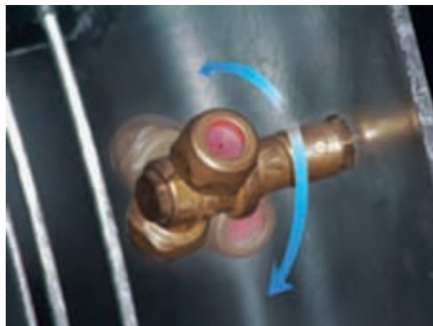
Imagen 13. Jet orientable para cambio de boquilla.
